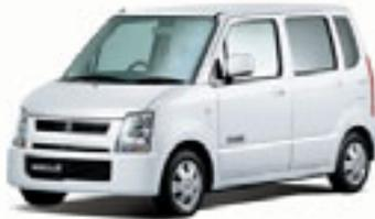
2004年5月17日 スズキから新型「ワゴンR天然ガス自動車(CNG)」の受注が開始された。(ワゴンRCNGは受注生産)今回発売するクルマは2003年9月に**フルモデルチェンジしたワゴンRをベース**に、燃料ポンペをコンパクトに搭載することで、**ガソリン車とほぼ同じ居住空間**を実現、**大人4人がゆったりと乗車**できるとともに、定評あるワゴンRの使い勝手の良さをそのまま活かした設計としている。
